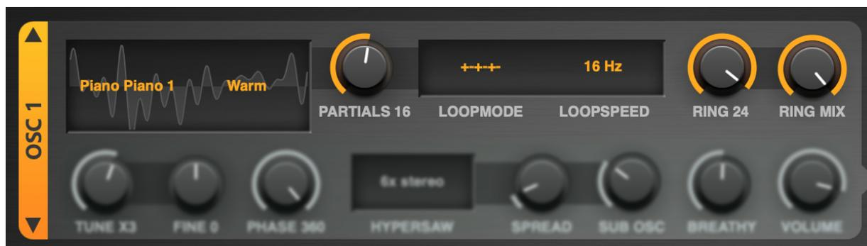
OSC1セクションとOSC2セクションは、本製品のサウンド生成部分を担います。このセクションでサウンドの基本的な音色が得られ、スペクトル的な変化、ハーモニック・コンテンツの再生をコントロールすることが可能です。84のスペクトラム・テーブルに14,000以上のスペクトルが含まれ、25種類ものアルゴリズムで変容させられます。各スペクトル・テーブルは基本的にオシレーターとして機能し、倍音が経時変化します。
